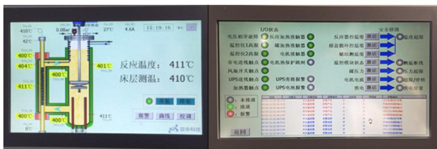
实时监控运行状态，全图形触屏控制，可灵活设置报警联锁。
